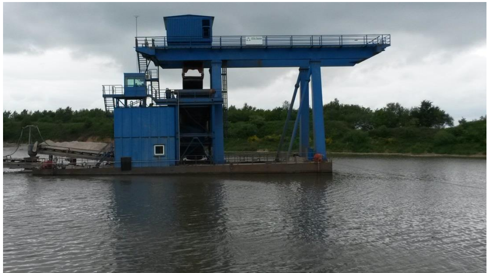
Figur 4.6: Dybdegraver der indvinder under grundvandsspejlet på større åbne søarealer. Indvindingen sker ved nedsænkning af grab ved hjælp af en wire.
