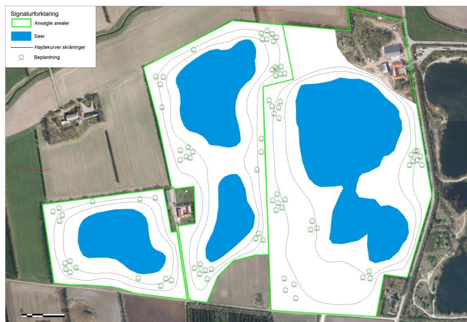
Figur 4.8: Efterbehandlingsplan for de vestlige arealer matr. nr. 28, 3b og 7 Mjøl, Rise. Størrelse og udformning af søerne kan variere i forhold til det viste.
