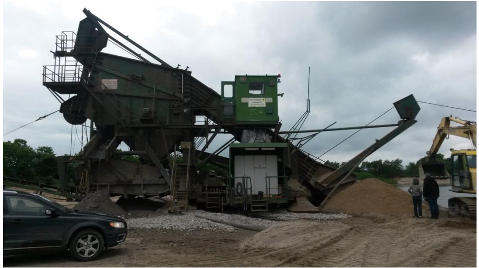
Figur 4.5: Slæbespil der anvendes til indvinding under grundvandsspejlet. Til højre i billedet ses en wire der trækker en slæbeskovl henover bunden af søen.
